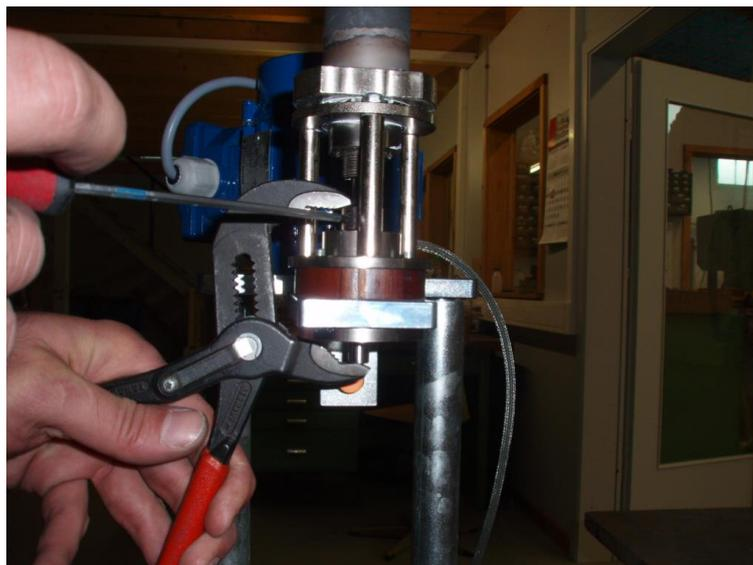
7. *Riemenscheibe Turbinenrohrseite (3/22)* aufschieben, an der Sicherungsscheibe (DIN 6799-7) **anliegen** lassen und fest anziehen.
